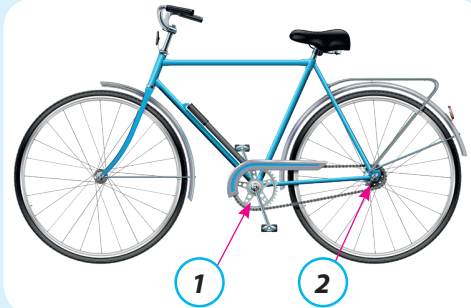
Мал. 118. Ланцюгова передача у велосипеді: 1 — повідна шестерня; 2 — ведена шестерня
