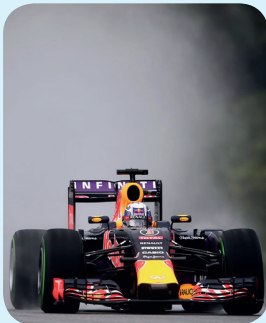
Мал. 81. Приклади низького розташування центру ваги в техніці
